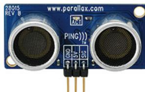
Figure 4. Parallax Ping))) Sensor
